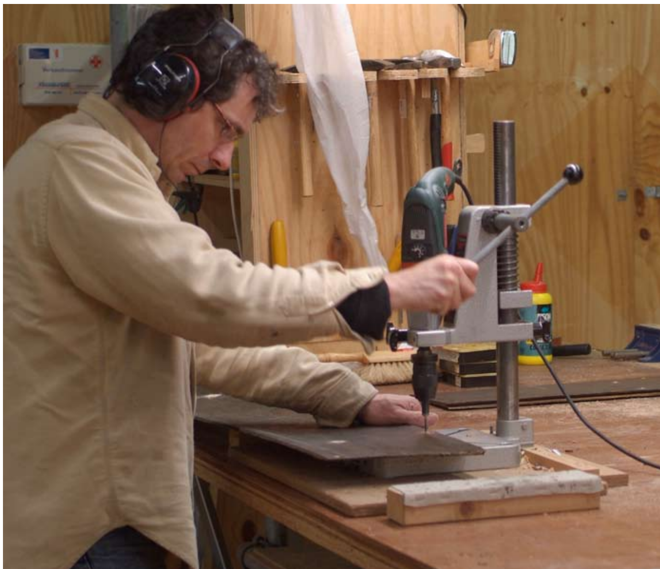
Afbeelding 17: Doorboren van de schachtgaten in de vastgelijmde montageproppen.
