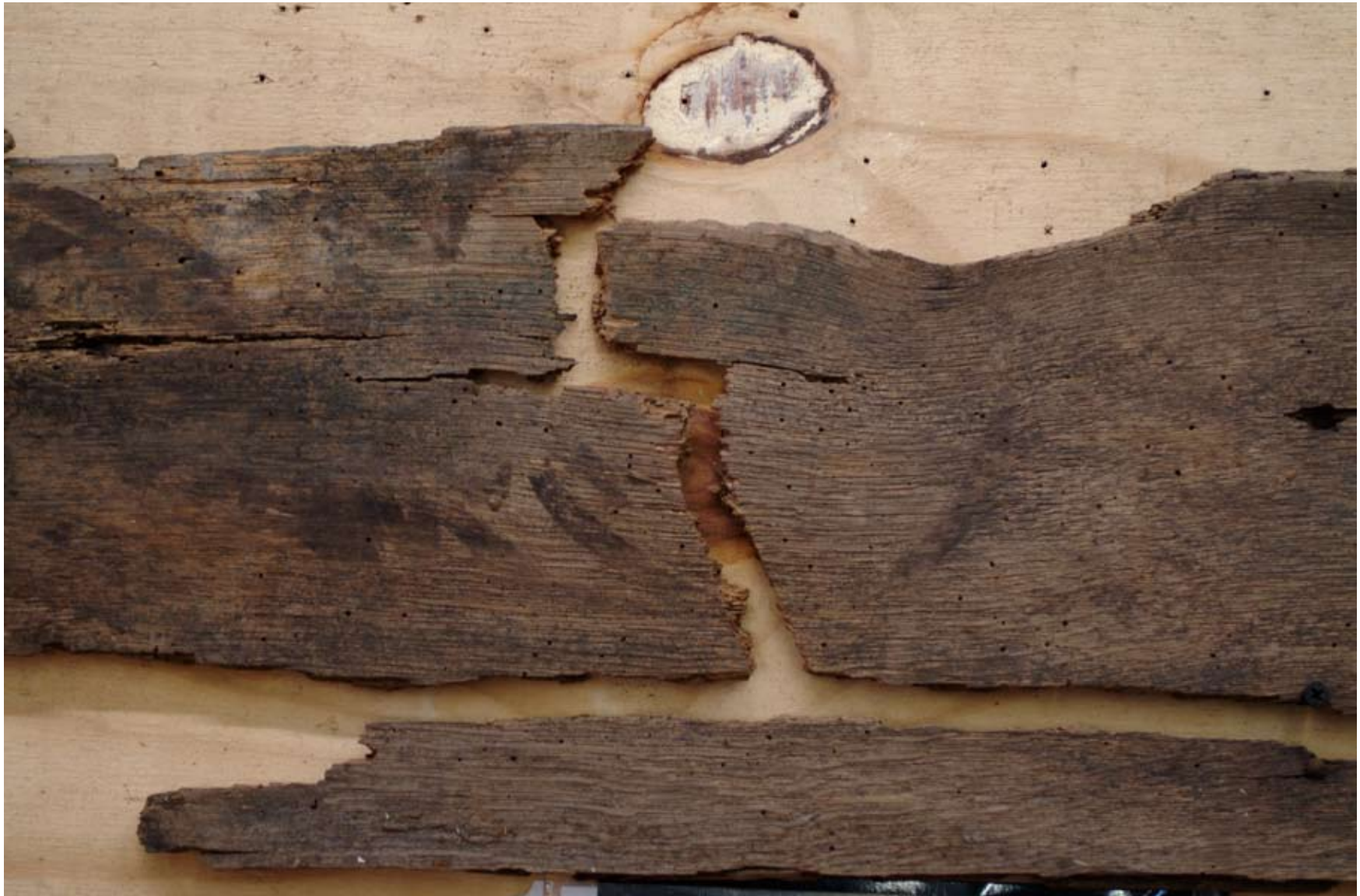
Afbeelding 12: Haakse breuken in los fragment uit het transept.
