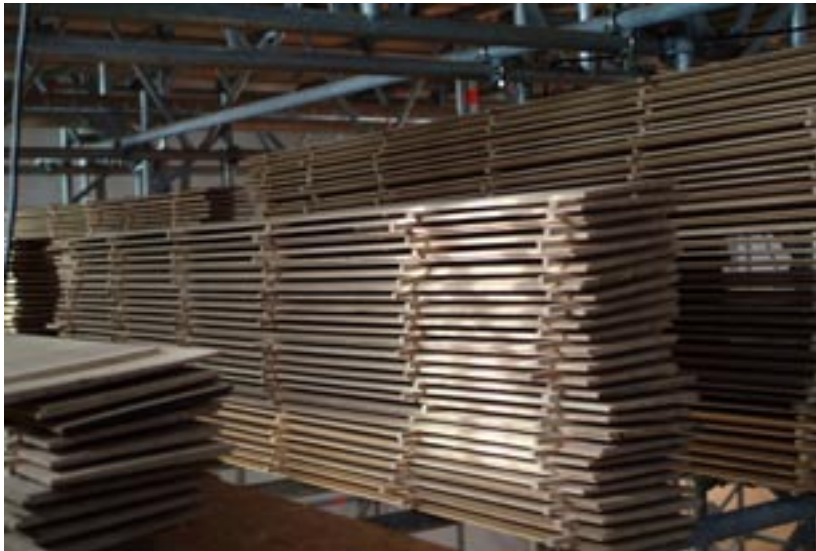
Links: nieuw wagenbeschot. Rechts: messing en groef
