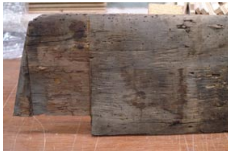
Boven: machinaal gezaagd; midden: hand gezaagd; onder: gekloofd
